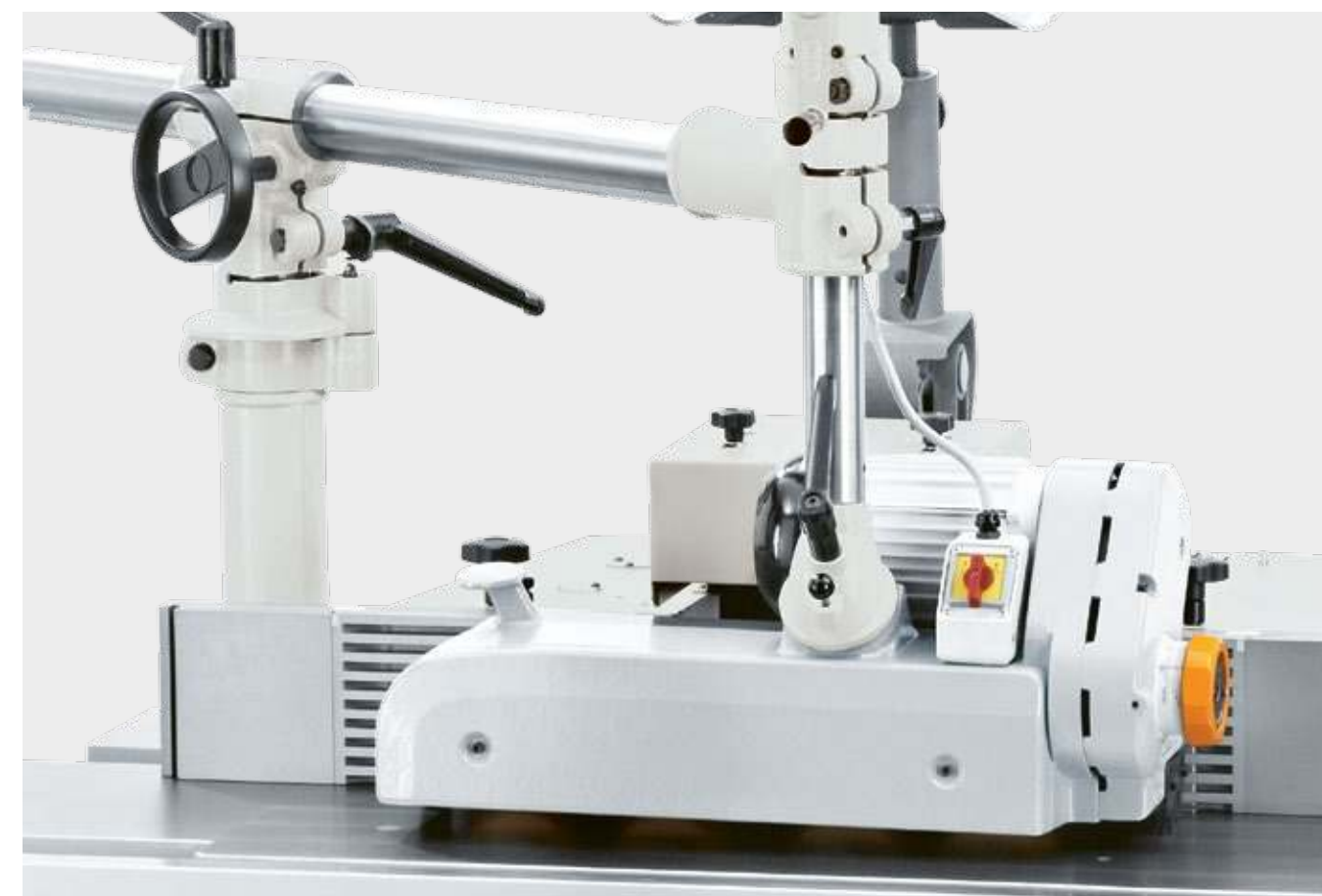
Posuw Variomatic 4N na komfortowym statywie | T1493_400 + T1491
