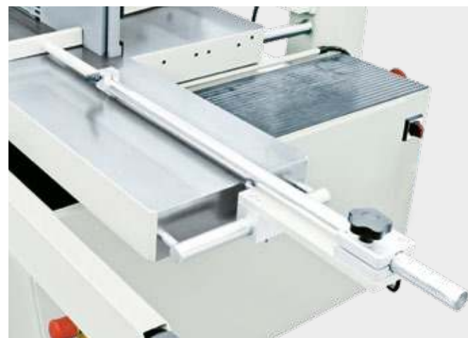
Ogranicznik do frezowania wglębnego | Txx35
