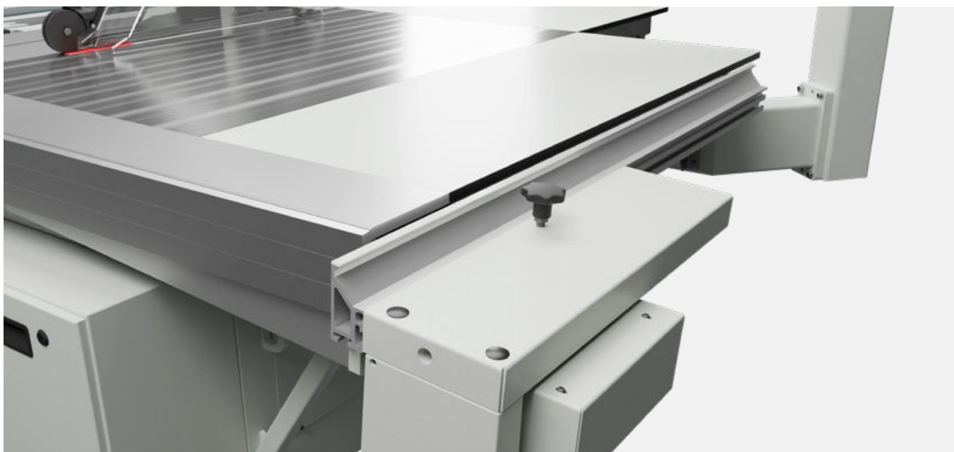
T77 Ogranicznik wzdłużny T7743 z szerokością cięcia 1100 mm | T7735/2
