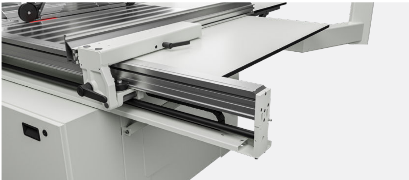
T66 Ogranicznik wzdłużny z szerokością cięcia 1350 mm | T6635/3
