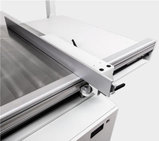
Parallelanschlag T66 | T77, Bewegung von Hand nach Skala
