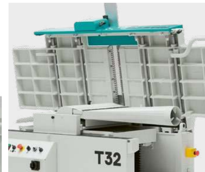
T32 gotowa do strugania grubościowego
