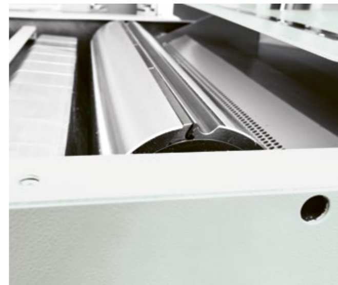
Wał nożowy TERSA | Standard
