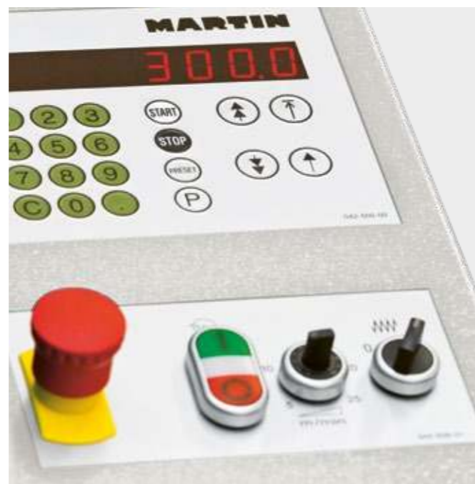
Regulowana bezstopniowo prędkość posuwu 5-25 m/min | T4510
