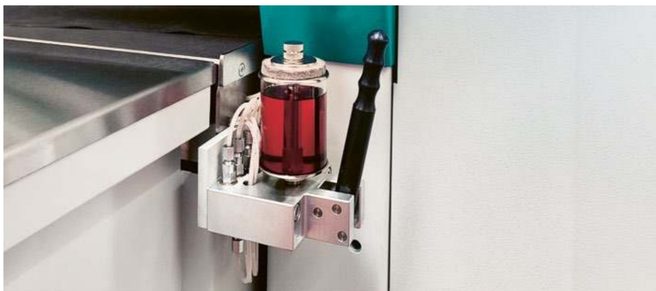
Układ centralnego smarowania | T4531
