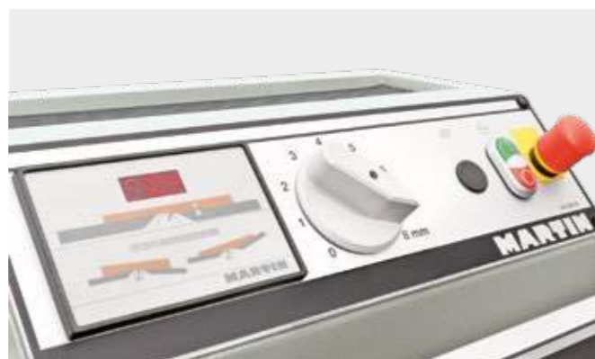
Panel sterowania połączony z przykładnicą i przesuwający się wraz z nią | T544
