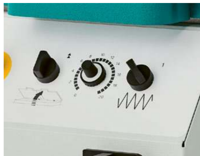
Bezstopniowa regulacja posuwu | T3221
