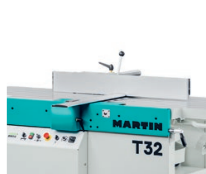
T32 gotowa do wyrównywania
