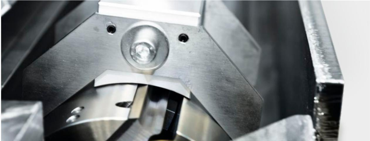
Cabezal de regleta de cuña con dispositivo de ajuste | T543
