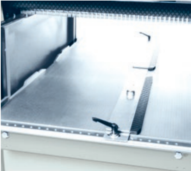
Zweiter Führungskamm für Profilierarbeiten | T4541
