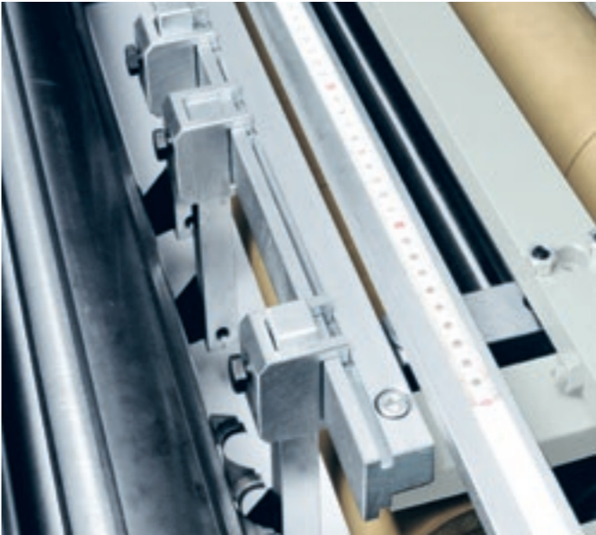
Sonderdruckeinrichtung für Profilierarbeiten | T4540
