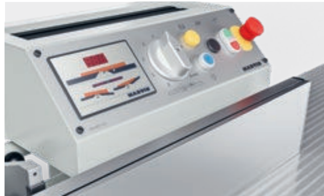
Bedienpult kombiniert und mitfahrend mit Abrichtanschlag | T544
