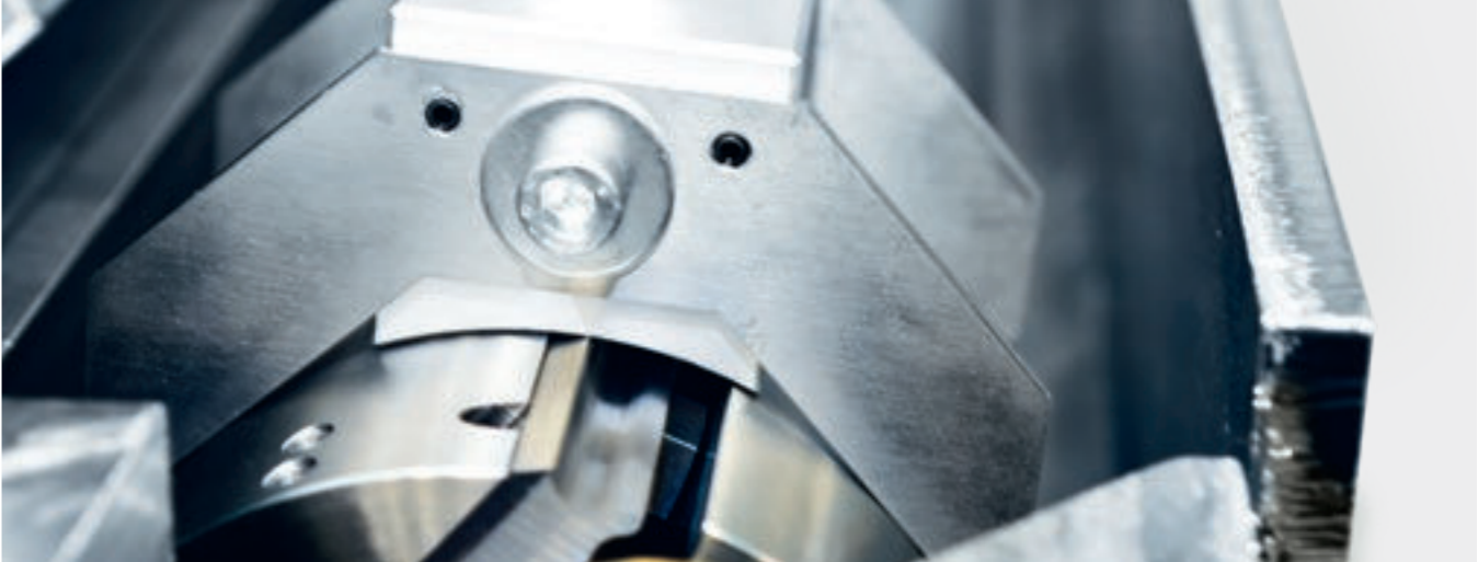
Keilleistenmesserwelle mit Einstellgerät | T543
