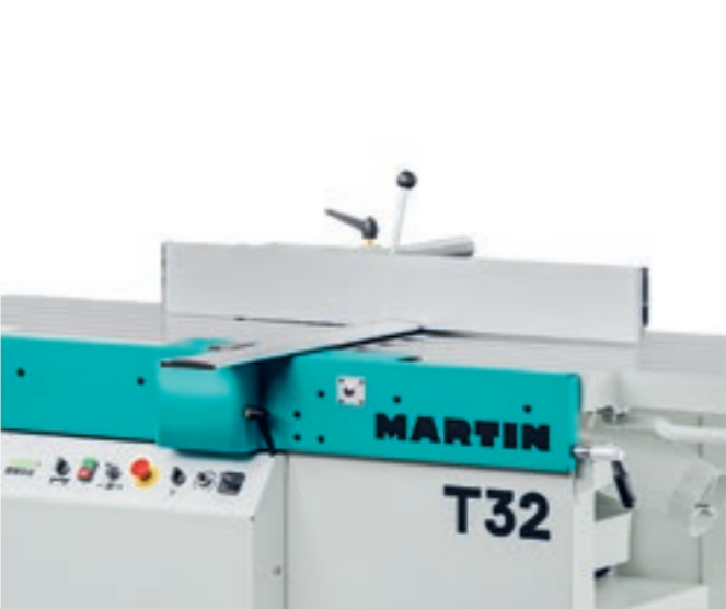
T32 équipée pour le dégauchissage
