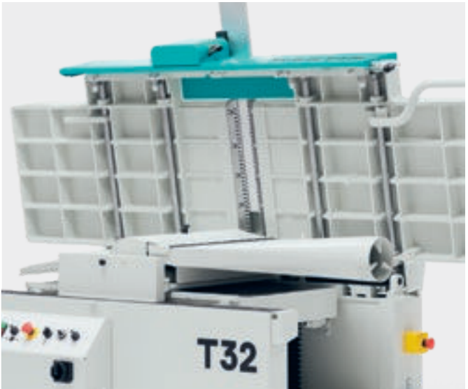
T32 équipée pour le rabotage
