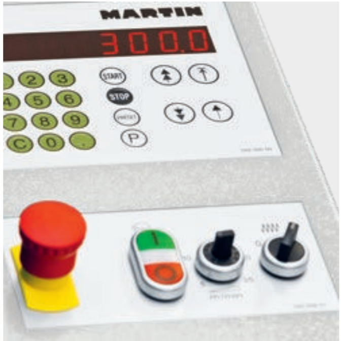
Velocità di avanzamento a regolazione continua 5 – 25 m/min | T4510
