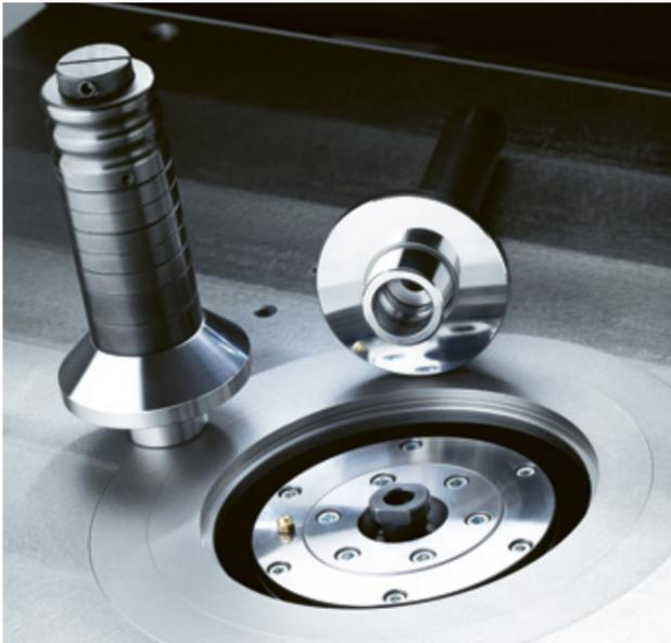
Fräsdornspannsystem HSK 63 F | Txx70\_63F
