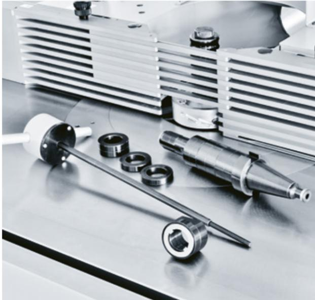
Fräsdornspannsystem SK40 | Standard
