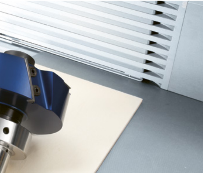
Système de serrage du mandrin HSK 63 F | Tx70_63F
