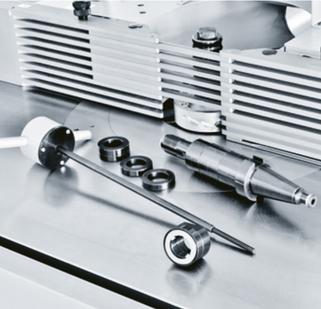
Système de serrage du mandrin SK40 | Standard
