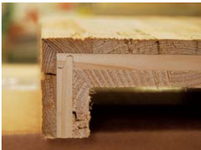
Bedarf einer exakten Einstellung: Verleimprofil für Gehungen
