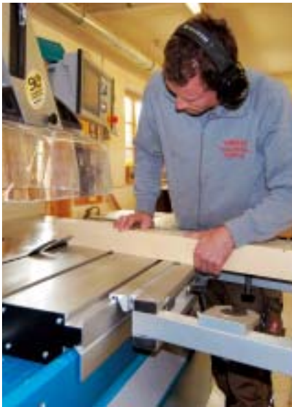
Martin Sattlberger führt einen Schifterschnitt an einem Gratsparren aus
