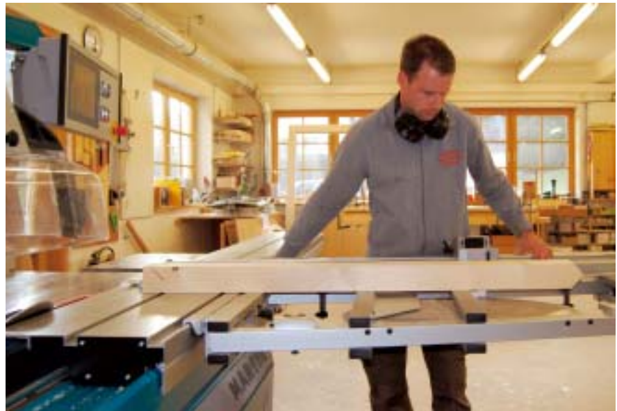
Den Winkel des Queranschlags stellt er manuell nach Digitalskala ein. Den Längsanschlag benutzt er nicht, weil es hier unkomplizierter ist, am Riss zu schneiden
