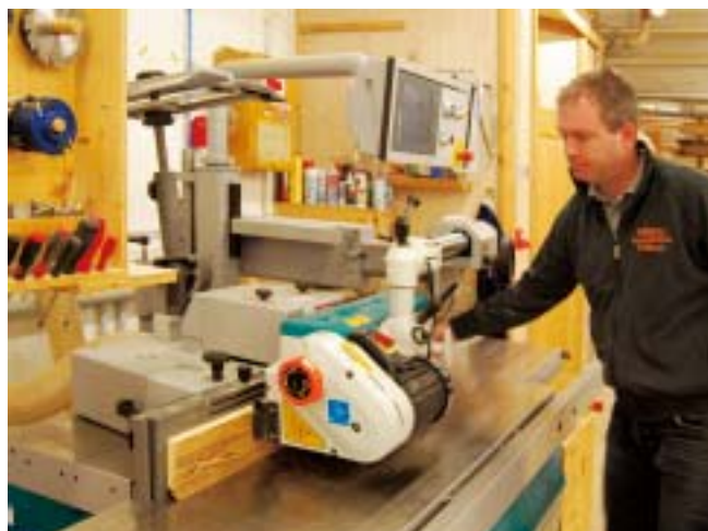
Das eine Stück läuft an der Fräsbacke, das Gegenstück flach auf dem Tisch
