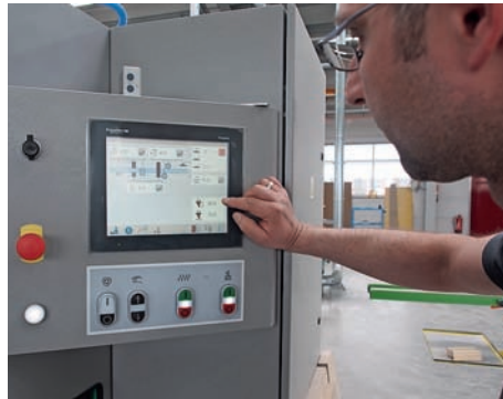
/ Als einer der ersten Holzfensterhersteller hat Putz in die Q-Fin-Technologie von Martin investiert. Am Touchscreen werden die Einstellungen vorgenommen, ...
