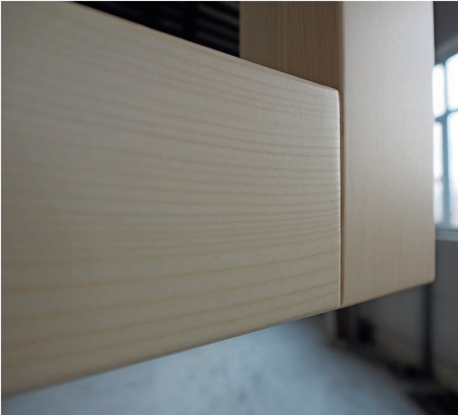
/ Durch die Bearbeitung der Teile auf der Q-Fin entfällt der Zwischenschliff im Bereich der Oberflächenbeschichtung in der Regel komplett. Der Prozess erfordert lediglich eine Sichtkontrolle, bei Bedarf punktuelles Nachglätten. Das spart jede Menge manuelle Arbeit und sorgt für eine Amortisationszeit von weniger als zwei Jahren.
