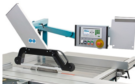
Die Spanhaube lässt sich mit wenigen Handgriffen positionieren
