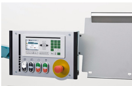
Einfach, aber auf die tagtäglichen Aufgaben ausgelegt: die 3,5"-Bildschirmsteuerung
