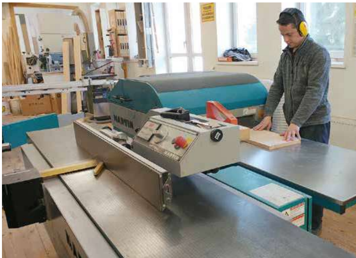
Strugarka grubościowa T45 Contour 25 gwarantuje, że wszystkie powierzchnie będą idealnie obrabione. Fot. mat. prasowe
