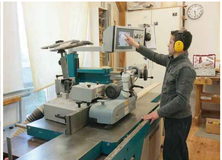
Frezarka ze stołem przesuwającym T27 wyposażona w nowoczesny sterownik z ekranem dotykowym. Fot. mat. prasowe
