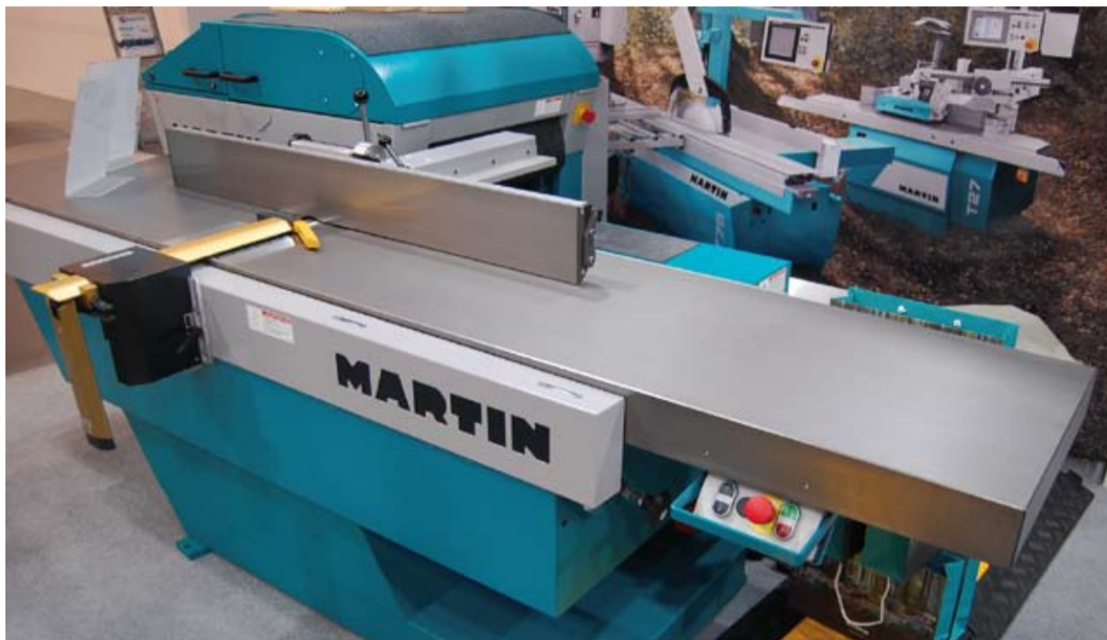
Grubościówka ma szerokość roboczą 63 cm.
