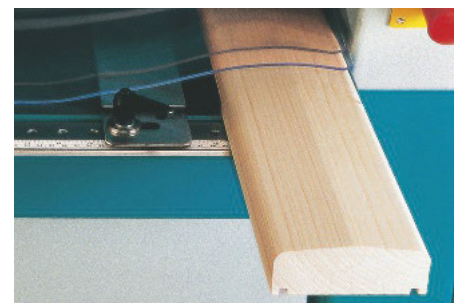
Komplex profiliert in nur einem Durchlauf
