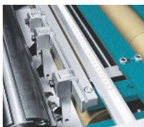
Unten links das Profilmesser der drei oben gezeigten Rundstäbe
